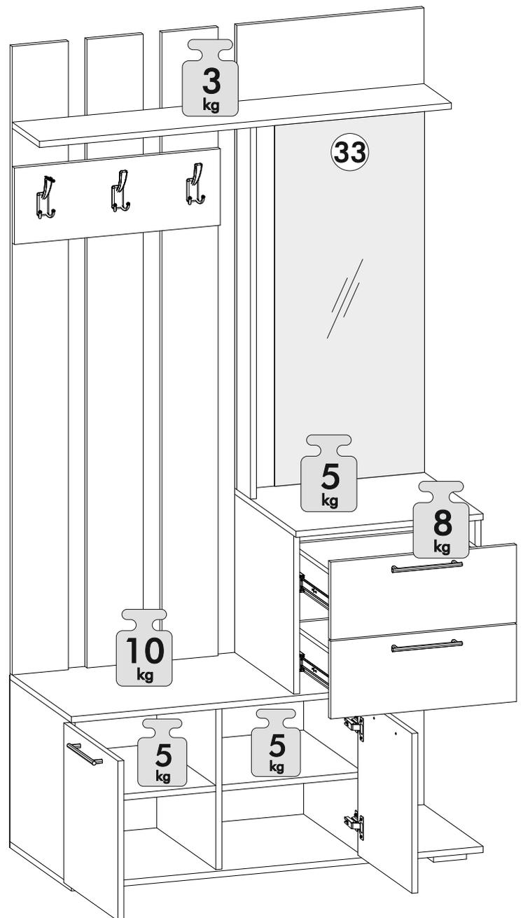
**Внимание!** Монтаж зеркал/стекел к фасадам производится самостоятельно на двусторонний скотч
